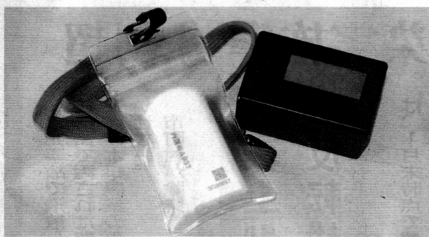
個人線量の管理に使われる新型の線量計。時間ごとの線量も表示され、生活実態に応じた被ばく量の把握が可能とされる
